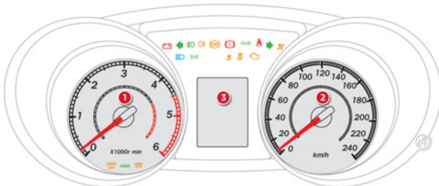
Painel que agrupa visores e avisadores, no sentido de informar o condutor acerca do funcionamento de um sistema (avisadores de funcionamento ou de neutralização) ou do aparecimento de uma anomalia (avisador de alerta).
