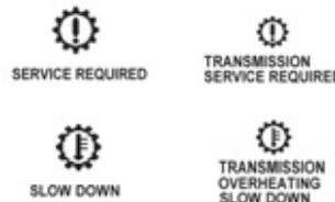
Estando a ignição ligada, o aparecimento da mensagem "**Abrandar**" ou da mensagem "**Manutenção necessária**" no ecrã do quadro de bordo indica um mau funcionamento da caixa de velocidades.
