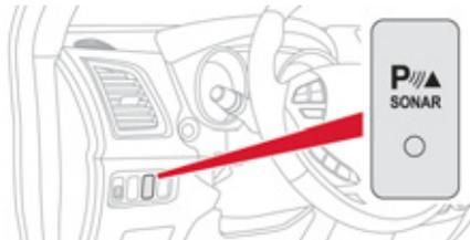
A colocação em funcionamento é obtida através da engrenagem da marcha-a-trás, sendo acompanhada de um sinal sonoro. O avisador da tecla acende para confirmar a activação do sistema. A função é desactivada quando se desengrena a marcha-a-trás.
