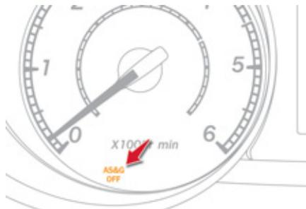
Em caso de problema de funcionamento do sistema, o avisador **"AS&G OFF"** pisca no quadro de bordo ou no visor do quadro de bordo e o sistema deixa de funcionar. Solicite a verificação junto da rede CITROËN ou de uma oficina qualificada.
