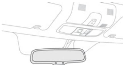
Graças a um sensor, que mede a luminosidade proveniente da traseira do veículo, este sistema garante de forma automática e progressiva a passagem entre as utilizações de dia e de noite.
