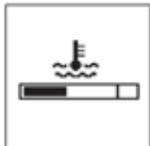
Com o motor ligado, é indicada a temperatura do líquido de arrefecimento.
