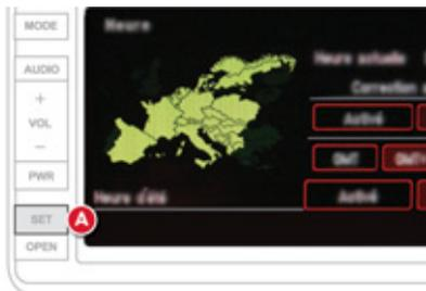
A regulação do relógio numérico é **automática**. Este modo permite ao sistema regular automaticamente a hora local utilizando o sinal das estações RDS.
